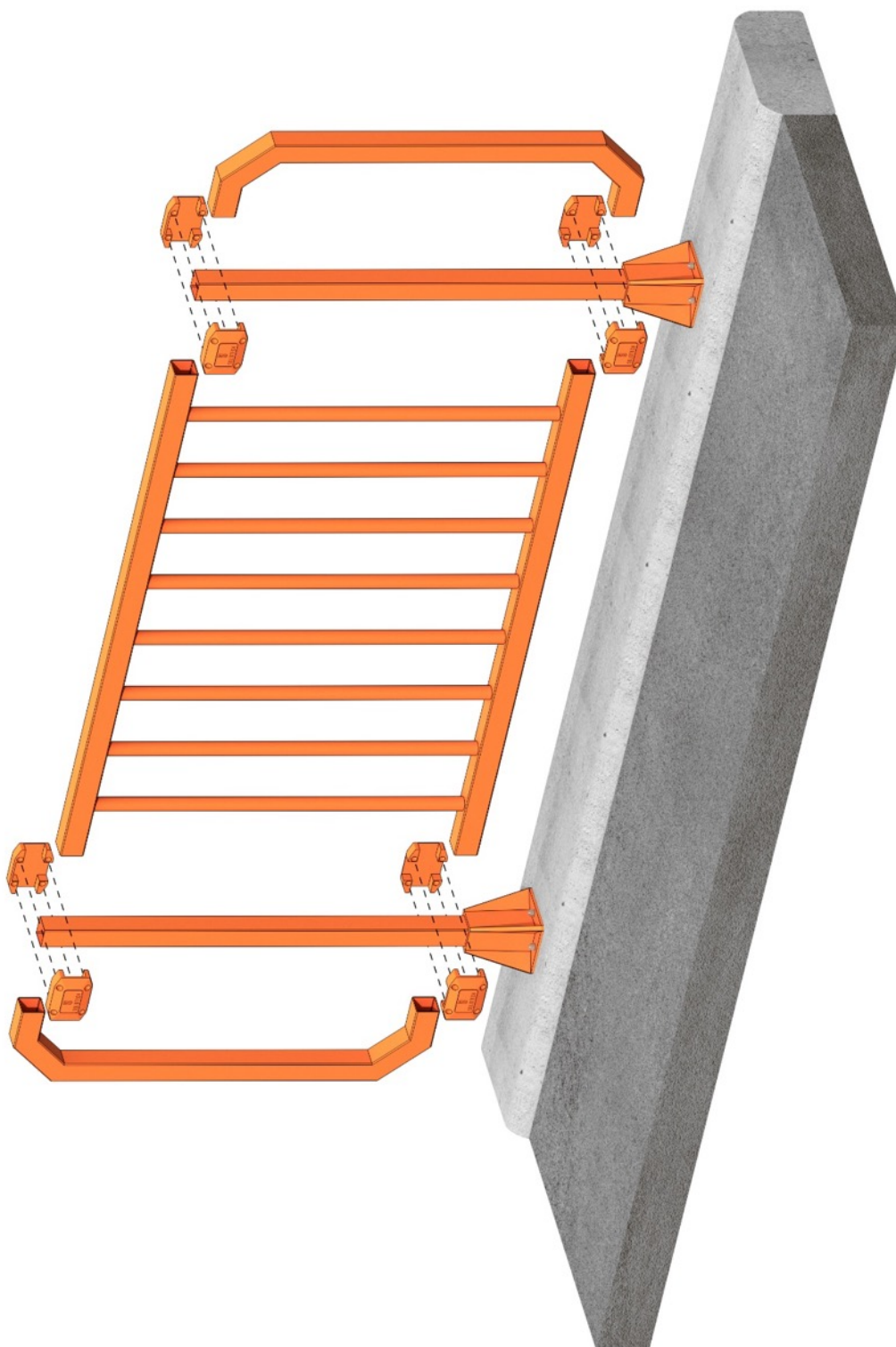
Рисунок А.3 Принципиальная схема сборки элементов ограждения УПО-М/1,1-1,5-СТО 02476652-001-2016
